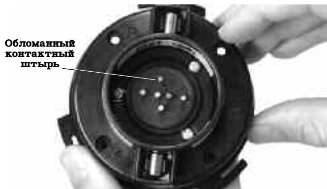
Рис. 12 – Обломанный контактный штырь
