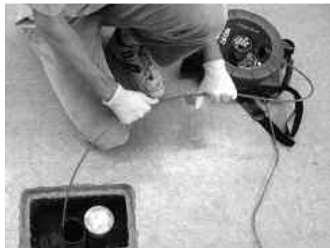
Рис. 29 – Образование петли из кабеля во время его проталкивания в барабан может привести к перегибу кабеля
