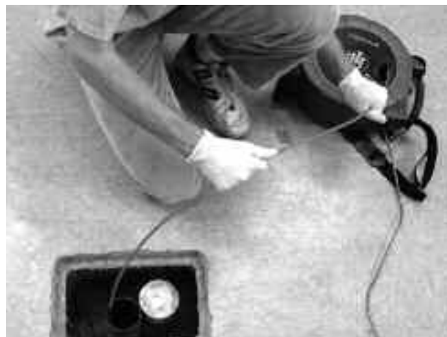
Рис. 28 – Надлежащий метод проталкивания кабеля назад в барабан
