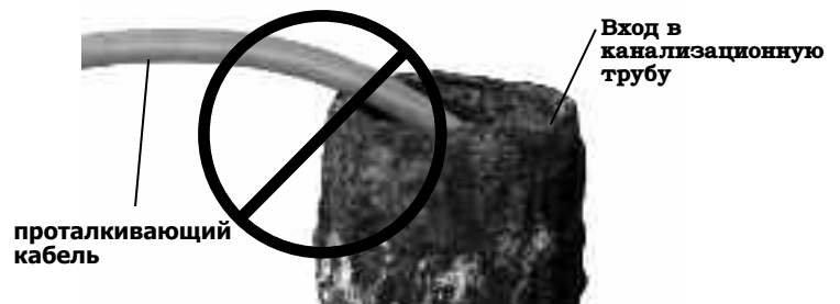
Рис. 23 – Не следует вытягивать кабель по острым кромкам
