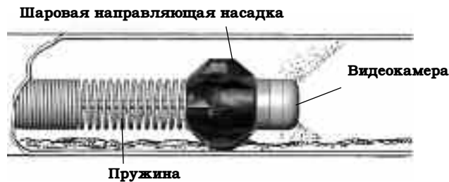
Рис. 24 – Положение шаровой направляющей насадки при работе
