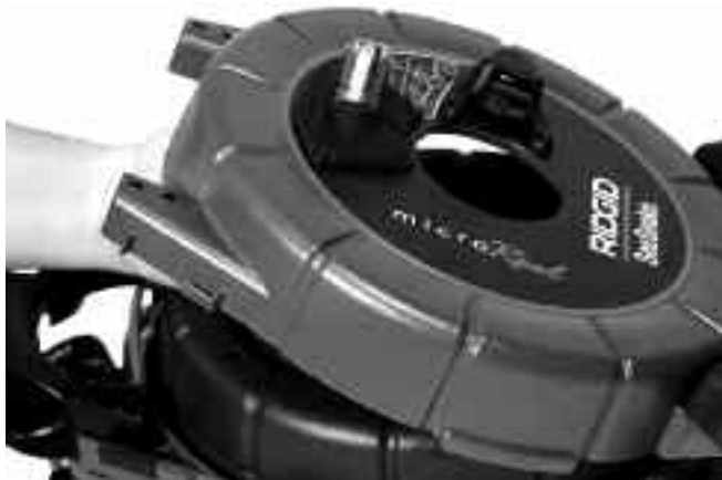
Рис. 5 – Осторожно откройте барабан, чтобы уложить кабель
